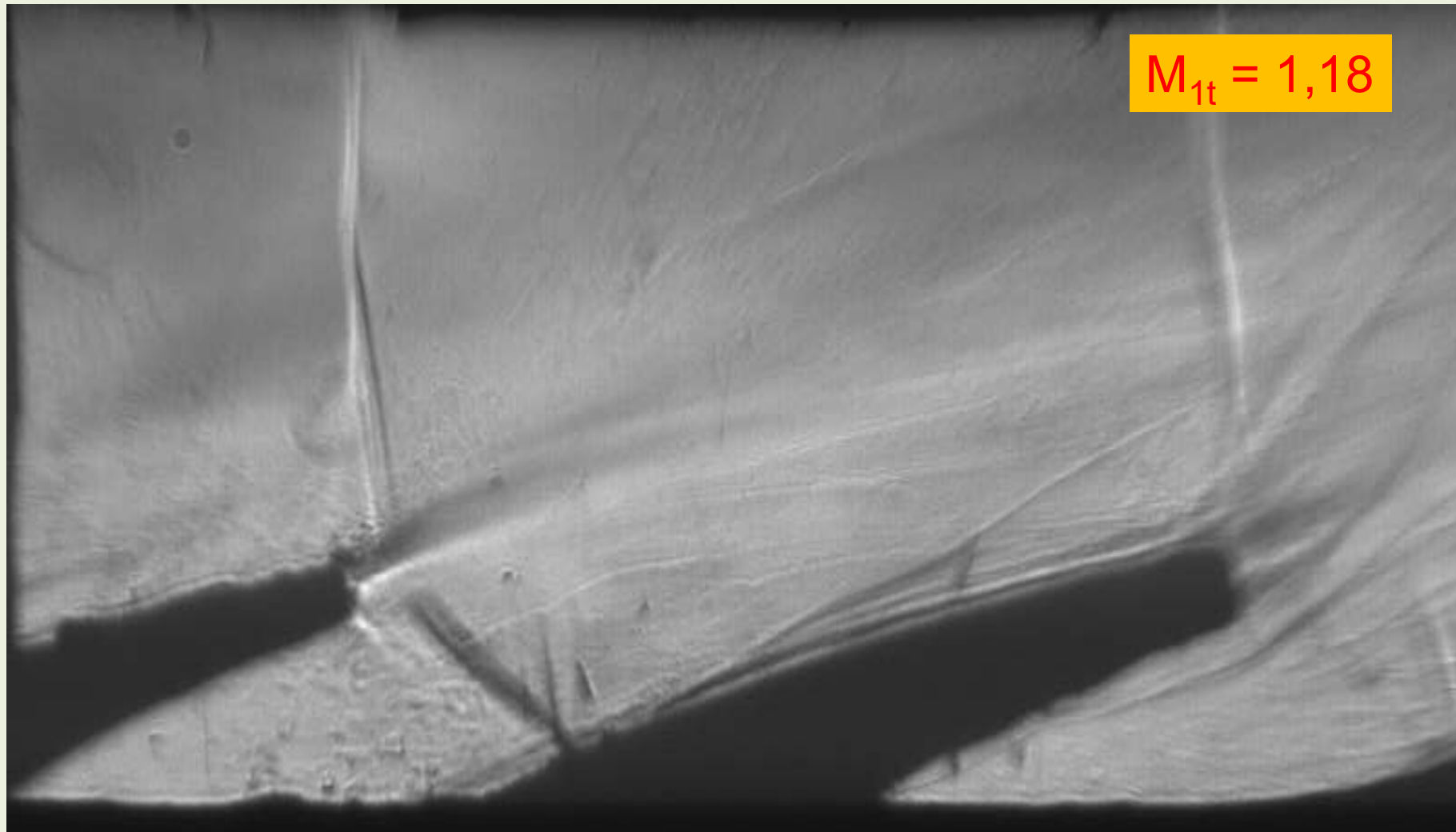
Волновая структура потока на насыщенном паре \Delta T = 0^\circ\text{C}
